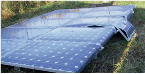
Korrekt befestigt, hätte dieses Modul dem Sturm standgehalten.
